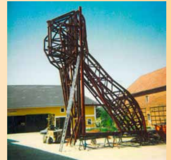
Anfertigung des Stahlgerüsts der Skulptur Puppy von Jeff Koons im Betrieb „Linzner Metallbau GmbH“, Alkoven 1992.
